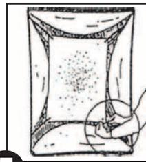
**5** ゴムの先きのスナップで、インナーバツフルを取り付けます。(1枚のみ)
