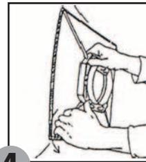
**4** ストロボヘッドを取り外し、ワズを後方へ引っ張るように外します。
